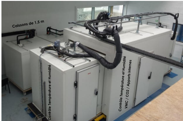
Essais sur parois (échelle réelle)
